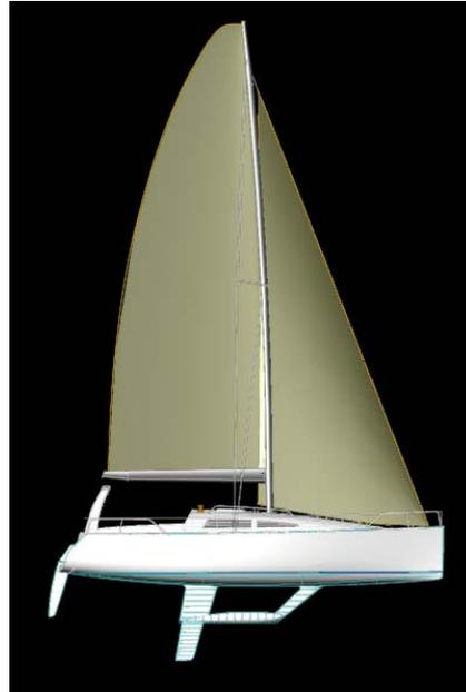
3) Seguridad y una robusta construcción: Buena estabilidad dada con el bulbo, estancos, casco y cubierta pegados y laminados, sumado a una buena construcción de detalles y terminaciones.
